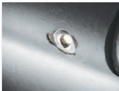
7. H3S-set te strak aangedraaid (scheuren). >
